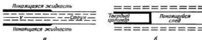
Рис. 9. а — прямая струя идеальной жидкости; б — след позади полуцилиндра в идеальной жидкости.
