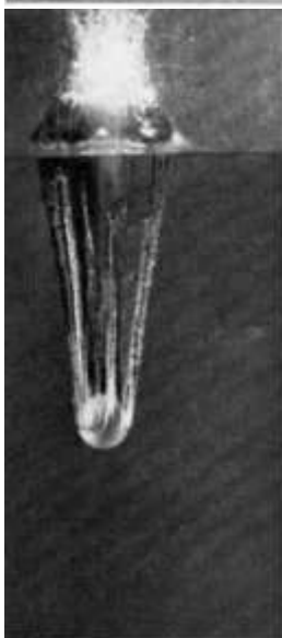
Фото 6.12.6. Каверна, образующаяся во время входа в воду сферы диаметром 9,9 см при скорости 340 см/сек (фотографировано ВМС США).
